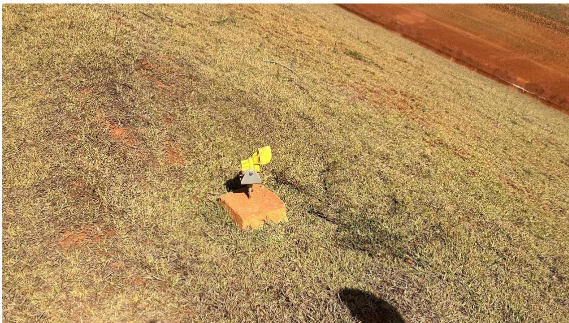
**Figura 78 – Marco topográfico instalado na Barragem B1.**
