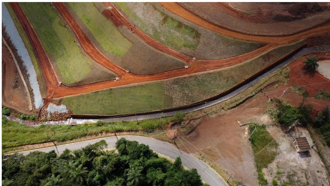
**Figura 43 – Canal extravasor (ombreira esquerda) Barragem B1 – abril/2023.**
