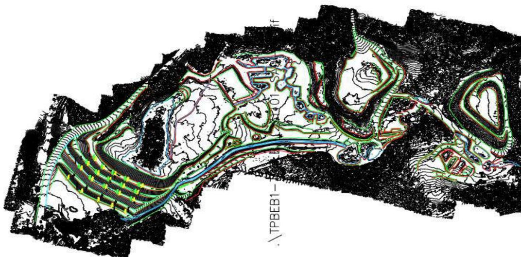
**Figura 6: Imagem esquemática do levantamento topográfico e batimétrico recente da Barragem B1. Novembro 23. Maiores detalhes no Anexo VII.**
