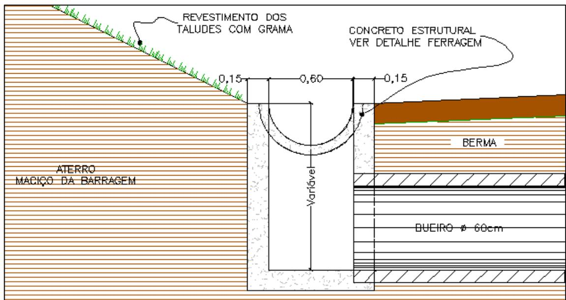
Figura 4 - Seção Tipo da Caixa Coletora com Bueiro de Greide
