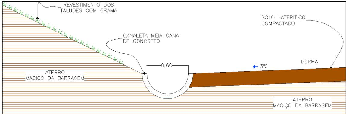
Figura 3 - Seção Tipo da Canaleta das Bermas
