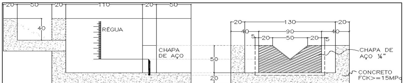
Figura 9 - Detalhe de Vertedouro Medidor de Vazão
