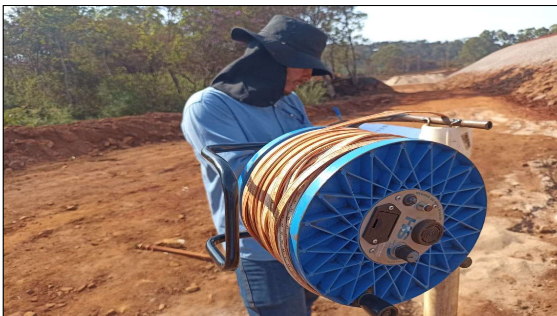
Foto 05 – Inspeção de Segurança Regular e monitoramento da instrumentação de controle. Registro em agosto de 2022.
