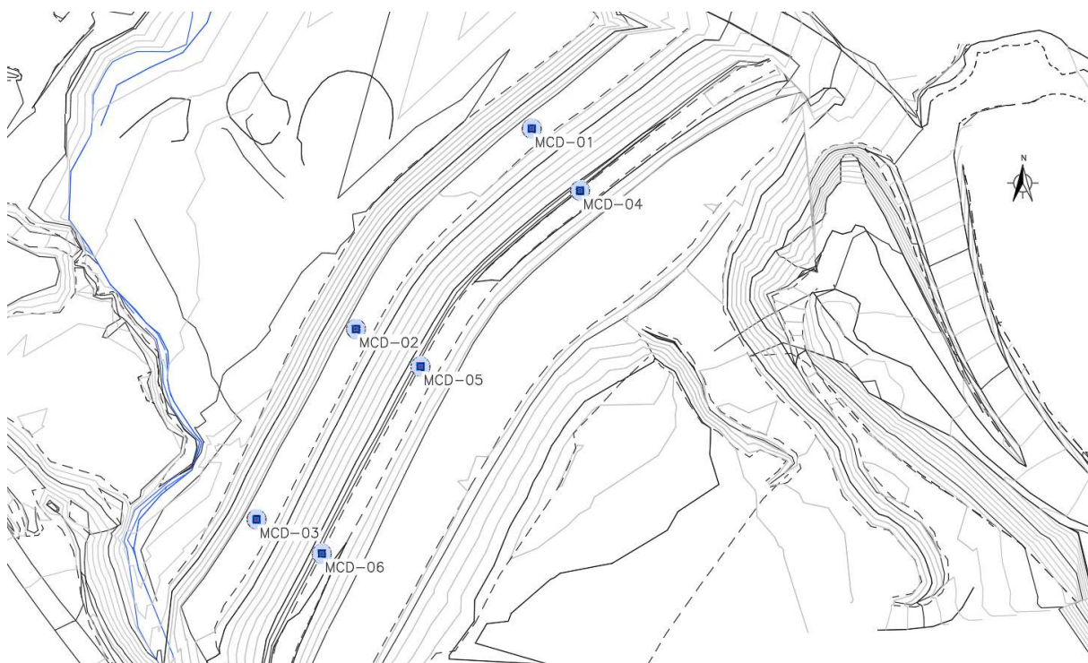
Figura 3 – Planta dos marcos de controle de deformação instalados no mês de julho
