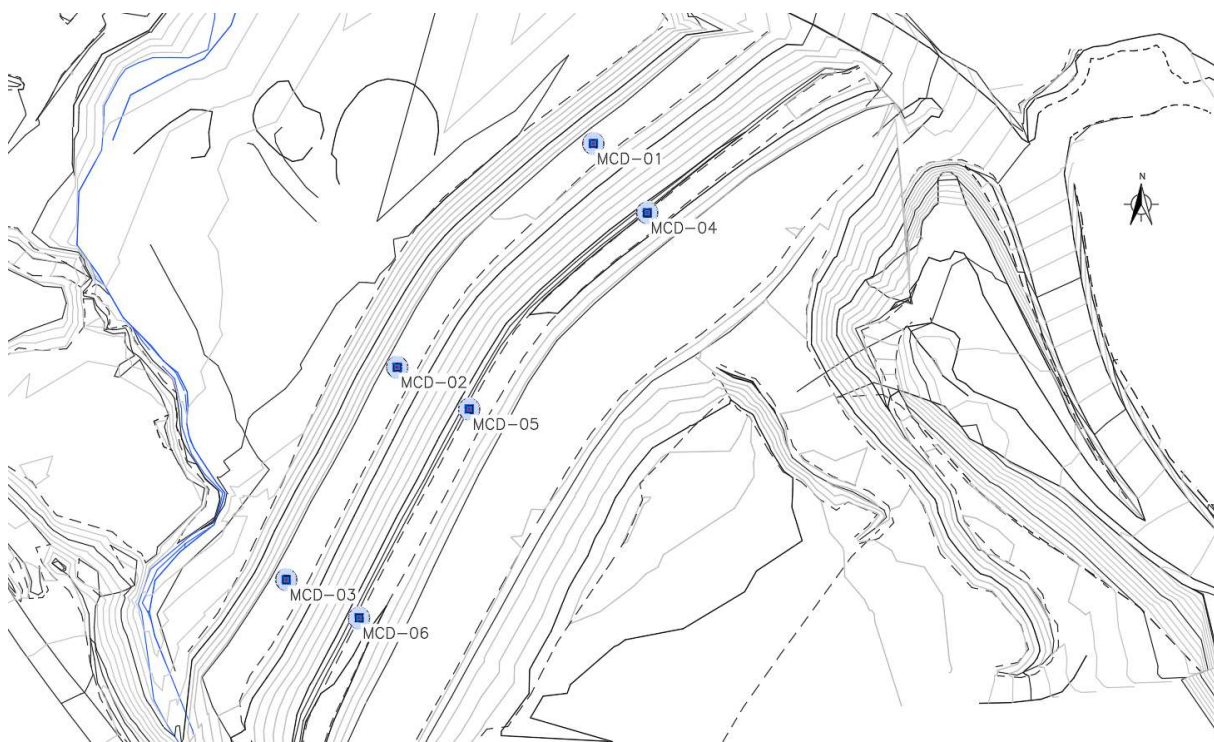
Figura 4 – Planta dos marcos de controle de deformação instalados no mês de julho
